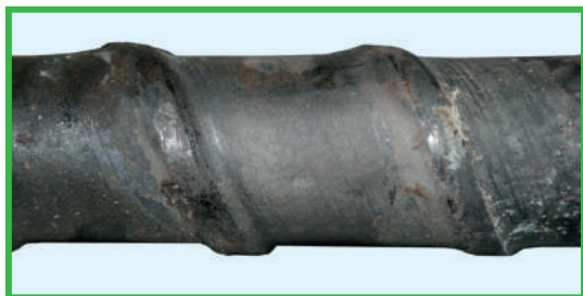
Schroef met afgesleten flanken en geruwde kern.
